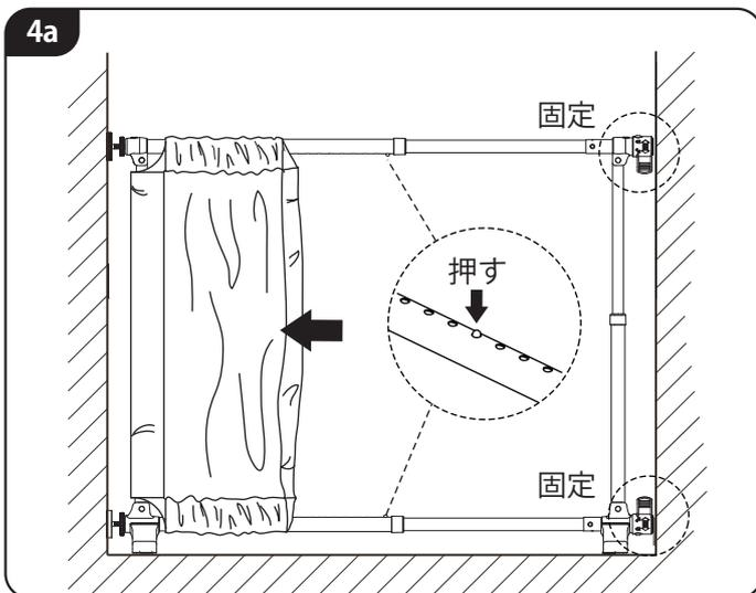
ゲートを設置予定の場所へ配置します。メッシュシートを片方に引き寄せ、伸縮メタルバーの固定ボタンを押し、ゆっくりバーを設置幅に届くまで伸ばします。
