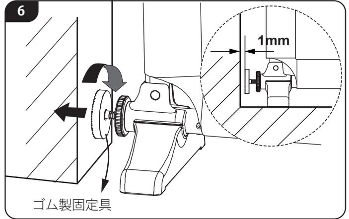
ゴム製固定具を伸ばして、設置面（壁）との隙間が 1mm となるようにしてください。
