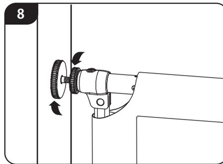
(8) 上下とも同様にゴム固定具を伸ばし、テンションノブを締めて、ゲートをしっかりと固定してください。
