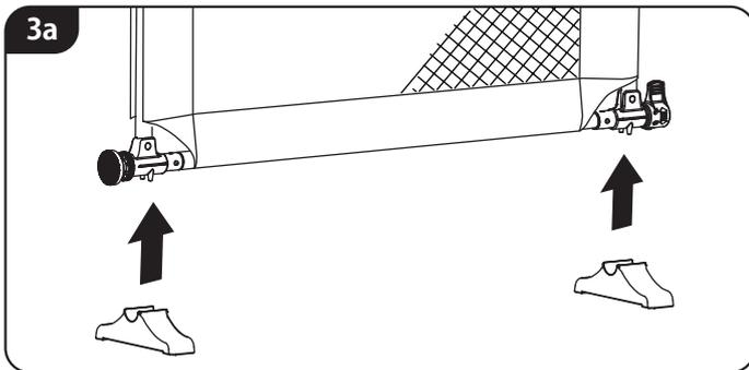
スタンド取り付け、ネジを締めて固定します。
